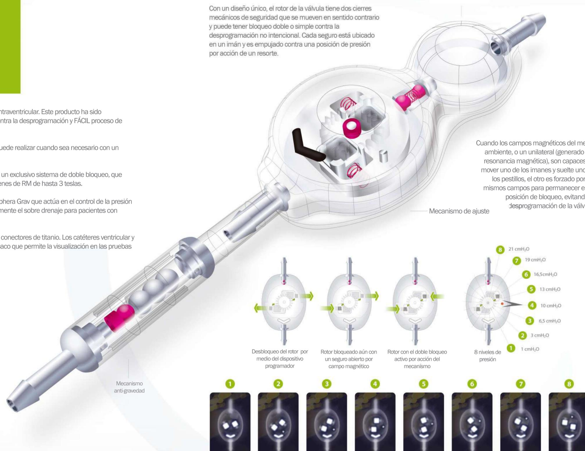
Cuando los campos magnéticos del medio ambiente, o un unilateral (generado por resonancia magnética), son capaces de mover uno de los imanes y suelte uno de los pestillos, el otro es forzado por los mismos campos para permanecer en la posición de bloqueo, evitando la desprogramación de la válvula.
